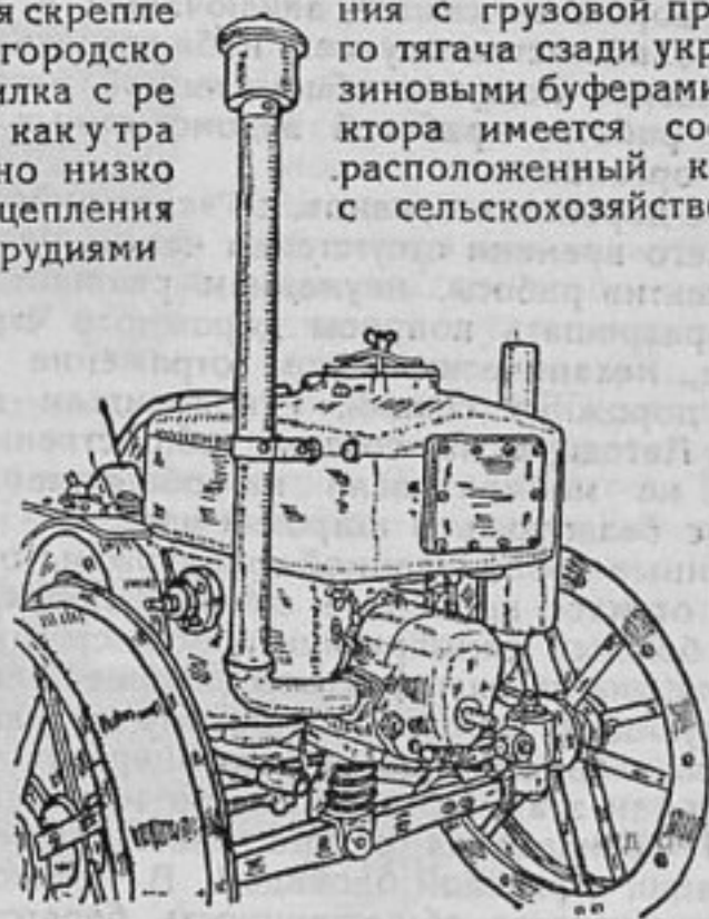
Вид дизельного трактора спереди; видна подвеска передней оси, а также резервуар с горючим и водой
